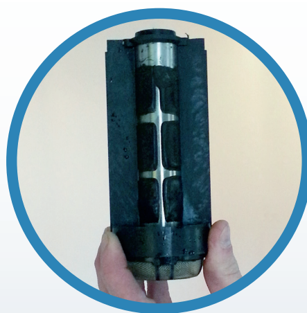
Boilermagin magneetti viikon käytön jälkeen.
